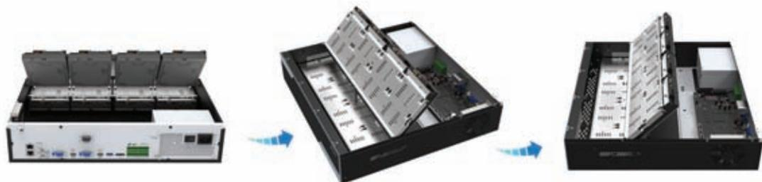
La nuova serie N8000 4K Pro supporta l'installazione fino a 4 HDD. La componente hardware è stata progettata e realizzata per una estrema facilità nell'installazione.
